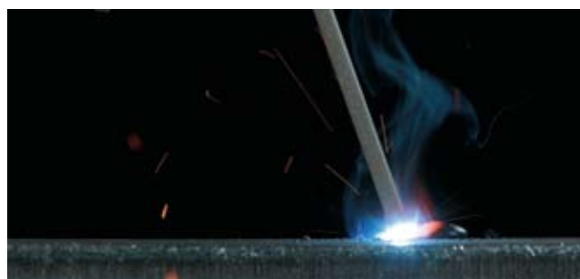
1) Электрод - 2) Флюсовая оболочка - 3) Металлический сердечник 4) Дуга - 5) Защитная атмосфера - 6) Сварочная ванна 7) Шлак 8) Наплавленный материал - 9) Основной материал
