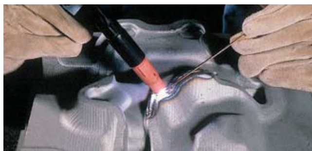
1) Горелка - 2) Защитный газ - 3) Присадочный пруток 4) Сварочная ванна - 5) Наплавленный слой - 6) Основной металл
