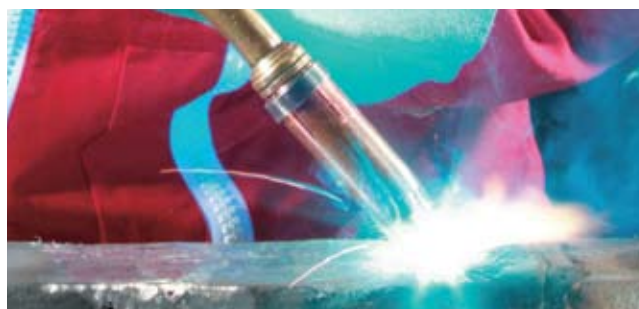
1) Газовое сопло - 2) Контактный наконечник - 3) Плавящийся электрод 4) Защитный газ - 5) Сварочная дуга - 6) Сварочная ванна - 7) Сваренный металл
