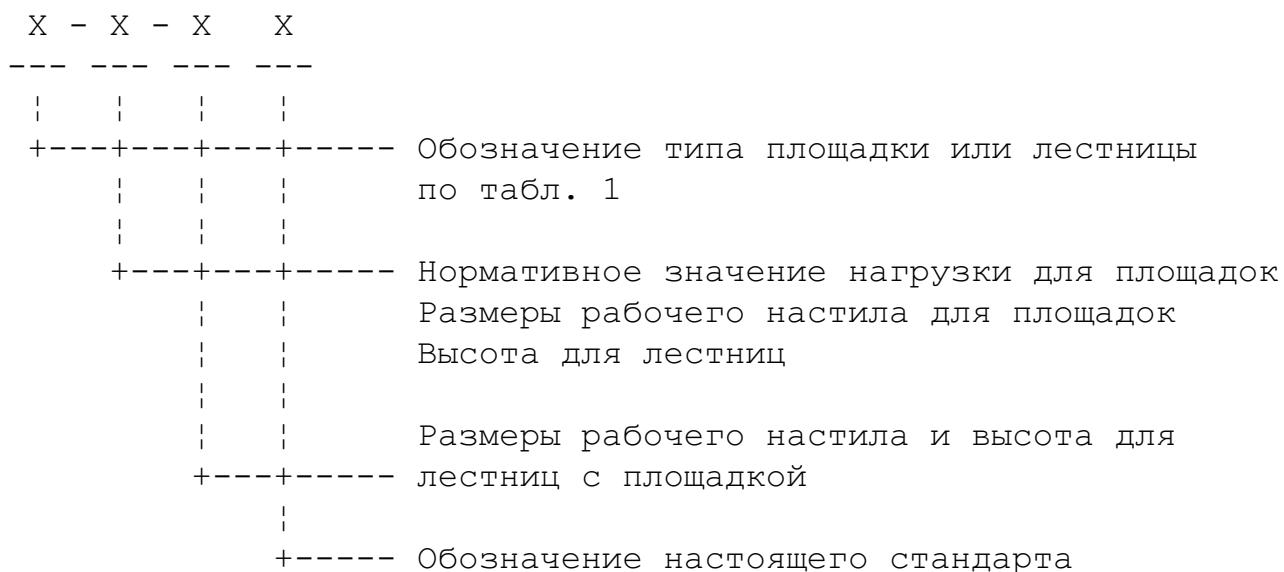
Пример условного обозначения площадок, навешиваемых на лестницы, из алюминиевых сплавов с нормативным значением нагрузки 1000 Н и размерами рабочего настила 0,6x0,6 м:
