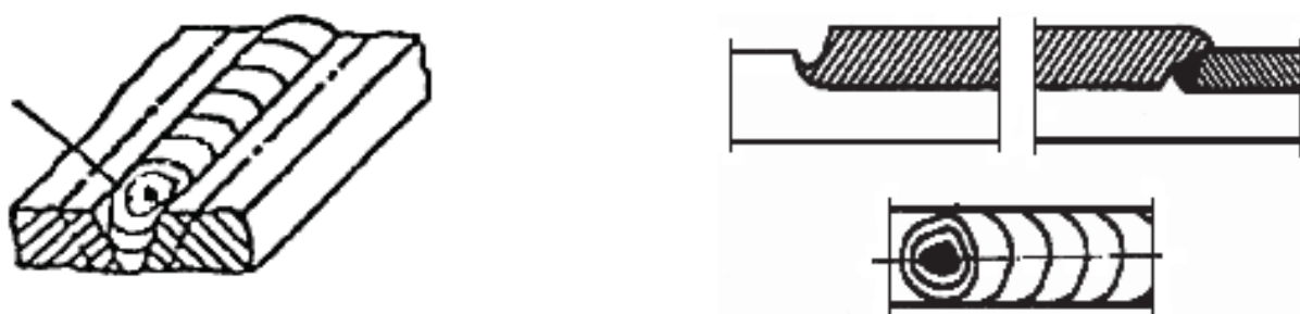
Рис. 1.30. Схематическое изображение поры сварного соединения
