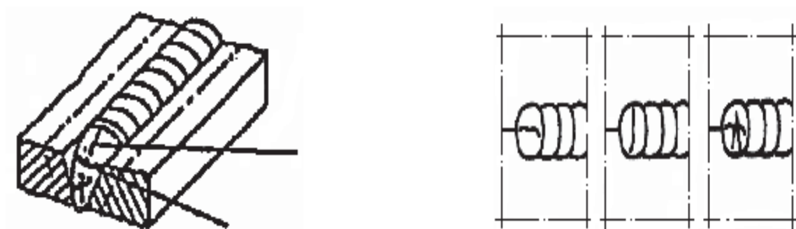
Рис. 1.8. Схематичное изображение кратерной трещины сварного соединения
