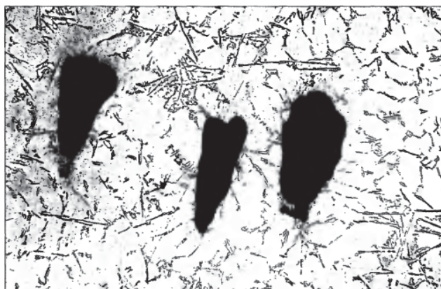
Рис. 1.55. Точечная неоднородность слитков (макроструктуры): а – равномерная (сталь); б – краевая (сталь)
