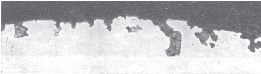
Рис. 2.61. Микрошлиф прутка с вдавленной окалиной
