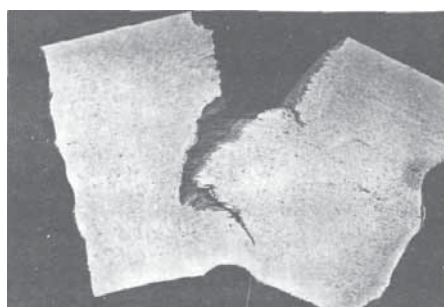
Рис. 2.65. Вырывы в центре прутка из стали 20, образовавшиеся при рубке: а — излом; б — макрошлиф
