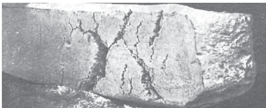
Рис. 2.32. Слиток с грубыми рванинами после первых обжатий при прокате
