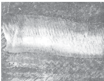
Рис. 2.9. Внешний вид волосовин: а – волосовины в местах зачистки сдутки из стали Х25Т; б – грубая волосовина в продольном микрошлифе стали 12Х18Н10Т
