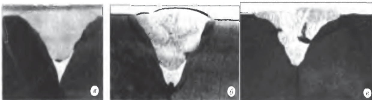
Рис. 1.43. Непровар (сталь, макроструктуры): а – корня шва; б – корня и кромки шва; в – между слоями
