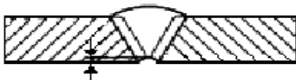
Рис. 1.49. Схематичное изображение вогнутости корня шва
