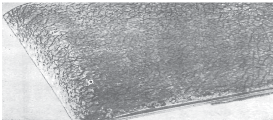
Рис. 2.37. Внешний вид заготовки с чешуйчатостью
