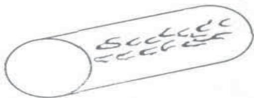
Рис. 2.35. Схема прокатных плен на прутке
