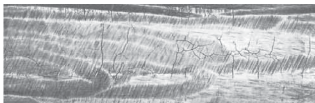
Рис. 2.70. Шлифовочные трещины: а – на сутунке сплава ХН68ВКТЮ (ЭИ578); б – на горячекатаной заготовке
