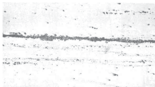
Рис. 2.8. Внешний вид прутков с грубыми раскатанными загрязнениями: а – пруток стали ШХ15; б – блюм стали 45
