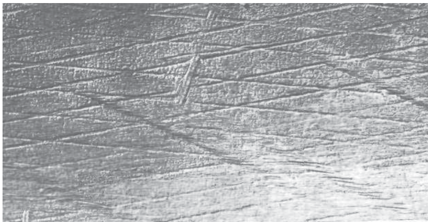
Рис. 2.52. Отпечатки на прутках от насечки в виде сетки на прокатных валках
