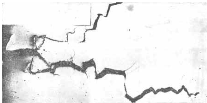
Рис. 2.71. Микрошлиф сплава ХН68ВКТЮ с шлифовочной трещиной
