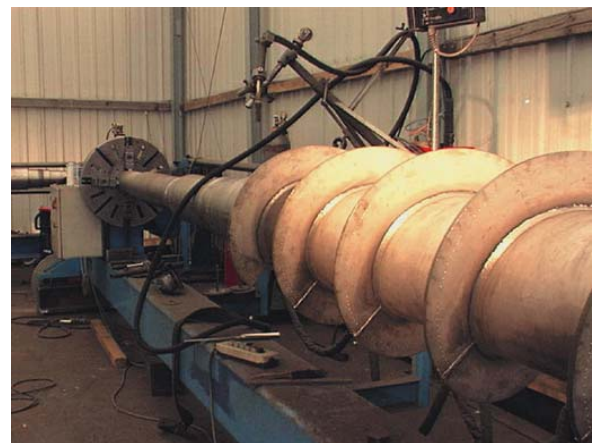
Рис. 4 Наплавка слоя высокой твердости на винтовые конвейеры
