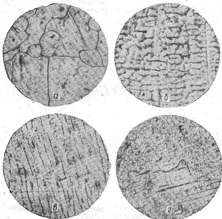
Фиг. 29. Микроструктура сварных швов никеля при автоматической сварке под керамическим флюсом, \times 135 .
