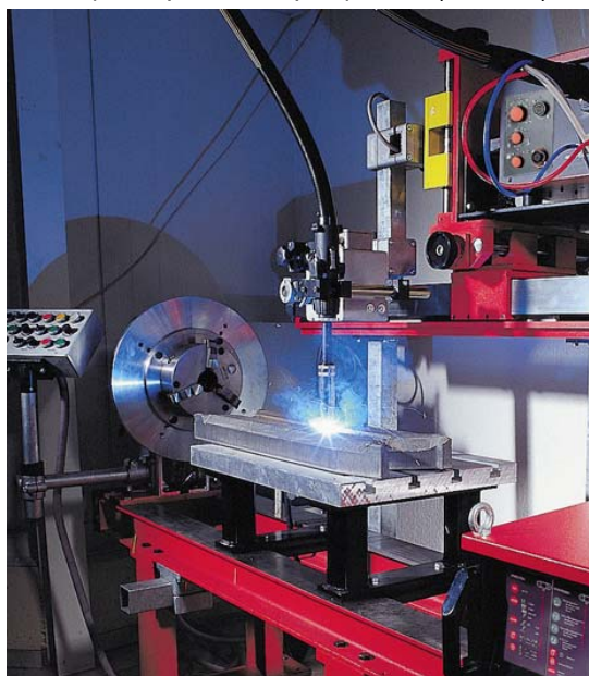
Рис. 36 Полностью механизированный процесс сваривания
