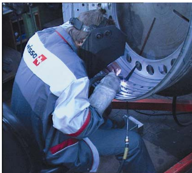
Рис. 31 Сварка ВИГ при ремонте деталей силового агрегата
