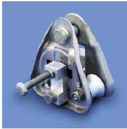
Рис. 5.7. Роликовый зажим SO 181.5. Для проводов сечением 35-120 мм 2 . Момент затяжки болтов 20 Нм.
